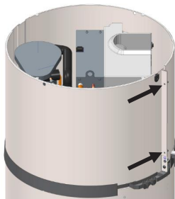
Dévisser les 2 vis du capot avant
